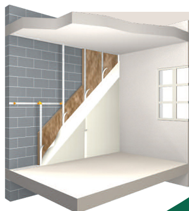
Doublage mur sur ossatures métalliques
